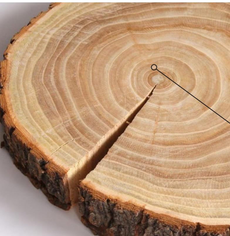
Отверстия, которые сужаются по направлению к центру бревна, называются усадочными трещинами. Такая древесина может использоваться в детских площадках, так как отверстия не считаются опасными для застревания пальцев. В процессе монтажа необходимо заострить острые края трещин.
