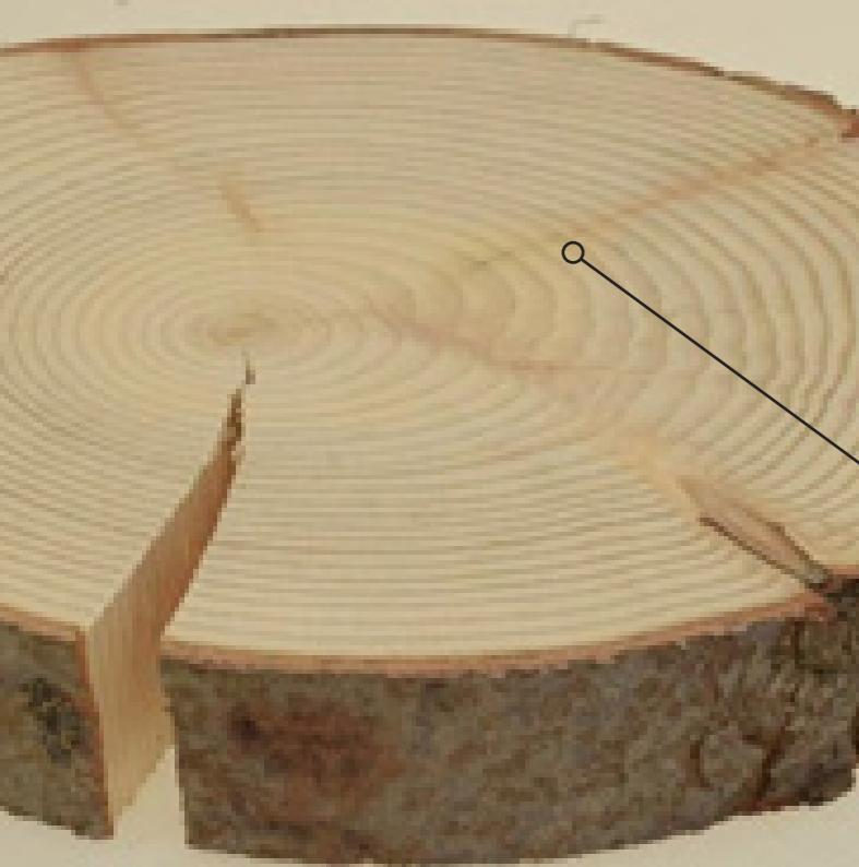
Трещины, возникающие на робинии, в основном поверхностные. Они не проходят внутрь ядра древесины и не способны расколоть её пополам. Такие трещины бывают боковые или торцевые.
