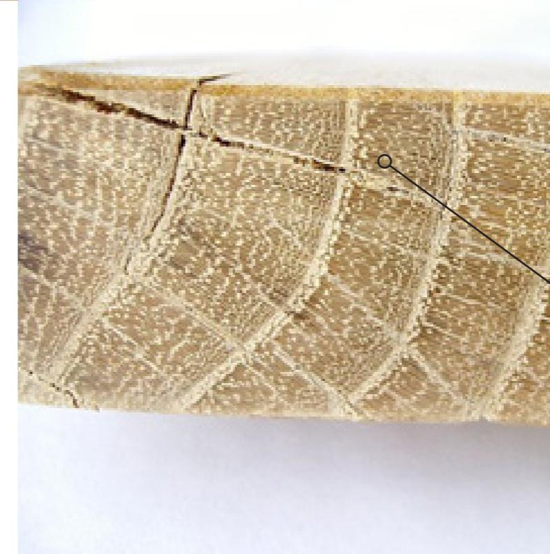
Торцевые трещины возникают чаще всего при неравномерной сушке древесины или при нарушении технологического процесса. Трещины появляются с торца ствола и не имеют выхода к боковой поверхности.
