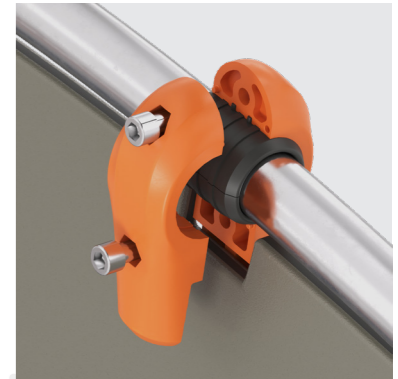
23 СОЕДИНИТЕЛЬ «HDPE-ТРУБА» Стеклонаполненный полиамид Предназначен для соединения трубы ДУ25 с HDPE-пластиком (15 мм).
