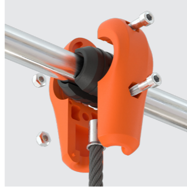
24 СОЕДИНИТЕЛЬ «ТРУБА-КАНАТ» Стеклонаполненный полиамид Предназначен для соединения трубы ДУ25 с канатом Ø16 мм.
