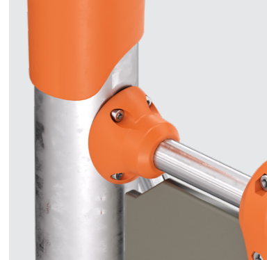
08 Т-ОБРАЗНЫЙ СОЕДИНИТЕЛЬ Стеклонаполненный полиамид Предназначен для соединения трубы Ø108 мм с трубой ДУ25 или с цепью.
