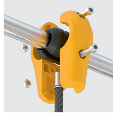
01 СОЕДИНИТЕЛЬ «ТРУБА-КАНАТ» Стеклонаполненный полиамид Предназначен для соединения трубы ДУ25 с канатом Ø16 мм.
