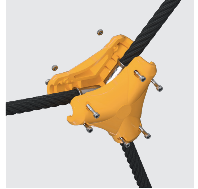
04 ТРОЙНОЙ СОЕДИНИТЕЛЬ Полиамид (нейлон) 6 (PA6) Предназначен для соединения трёх канатов Ø16 мм под углом 120 градусов.
